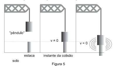
Quando erguido, o pêndulo ganha energia potencial gravitacional em relação ao solo e à estaca. Ao ser solto, perde altura e ganha velocidade. Nesse processo, sua energia potencial gravitacional se transforma em energia cinética.
