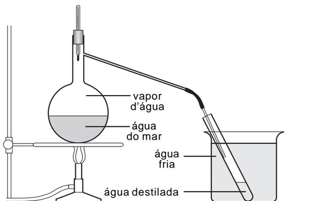
É difícil fazer isso em casa porque precisa-se de um aparelho especial: o **aparelho de destilação**.
