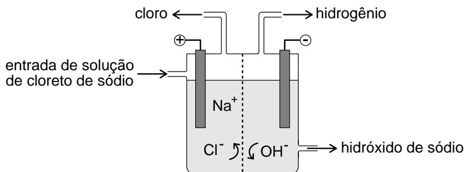
A reação é feita com o uso da energia elétrica, passando uma corrente elétrica por uma solução de sal em água.
