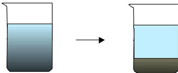
Ao deixar a mistura em repouso a areia sedimenta-se, inclinando o recipiente, a água esco, terminando o processo de decantação.
